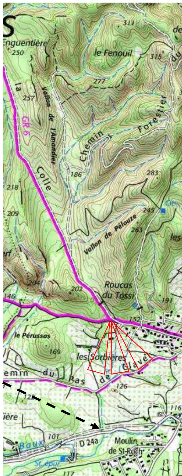
Figure 14 : le bassin versant du vallon de l'amandier et localisation du cône alluvial aval.
