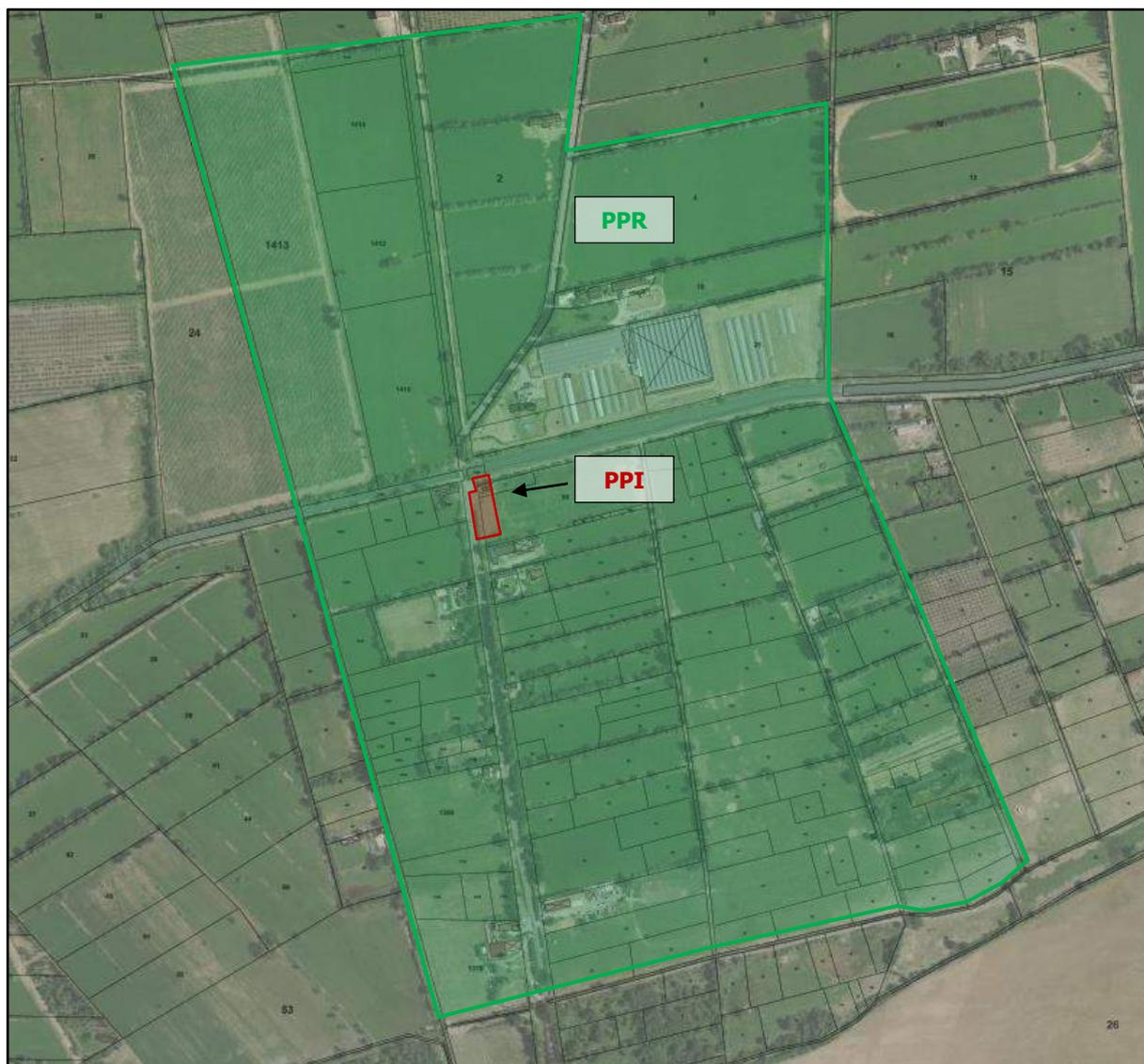
**Figure 2 : Délimitation des périmètres de protection de captage**
